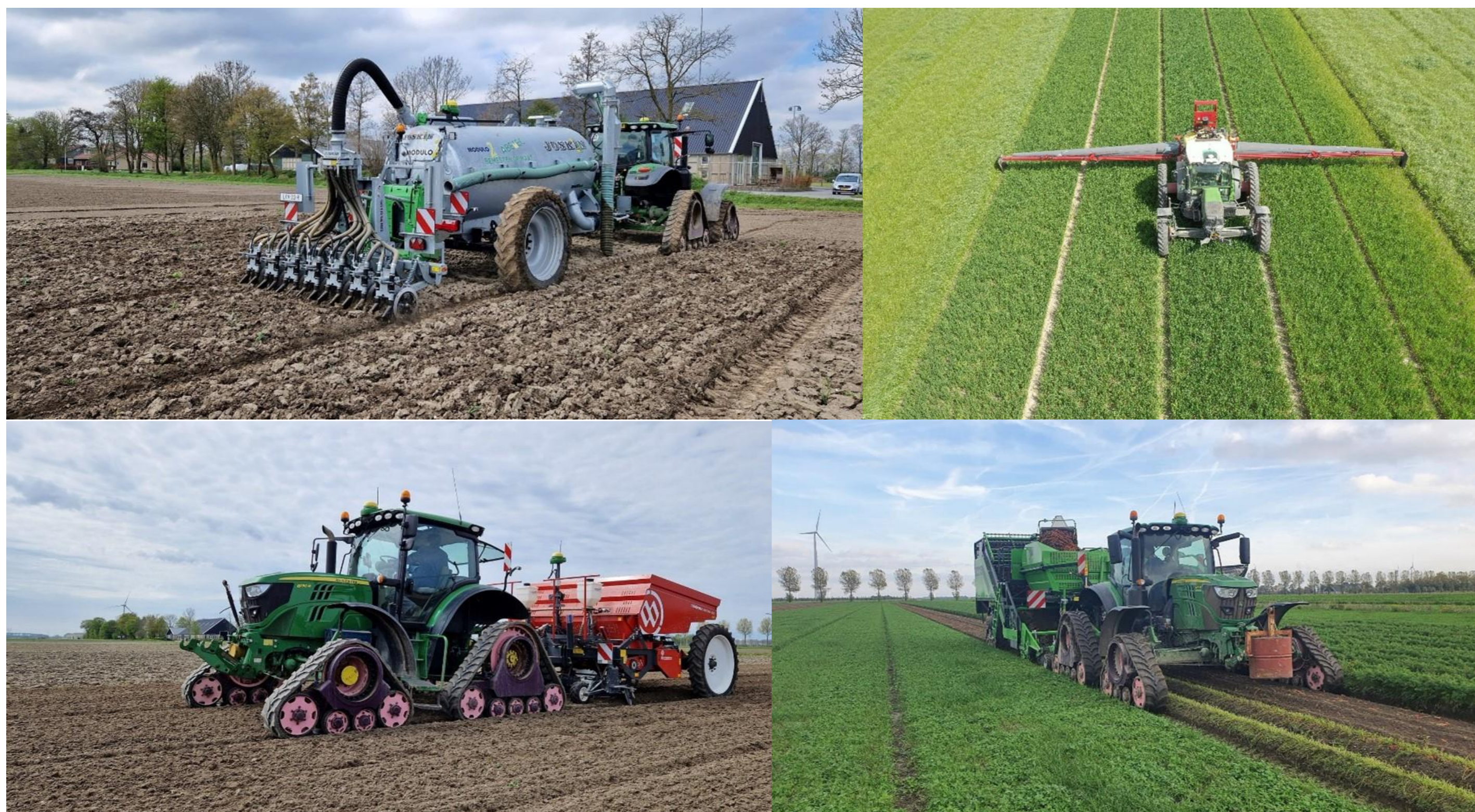
Figuur 1. Beelden van de slimme mechanisatie voor bemesting, planten, gewasbescherming en oogsten op vaste-rijpaden. De bemester en spuit hebben sensoren voor variabel doseren.
