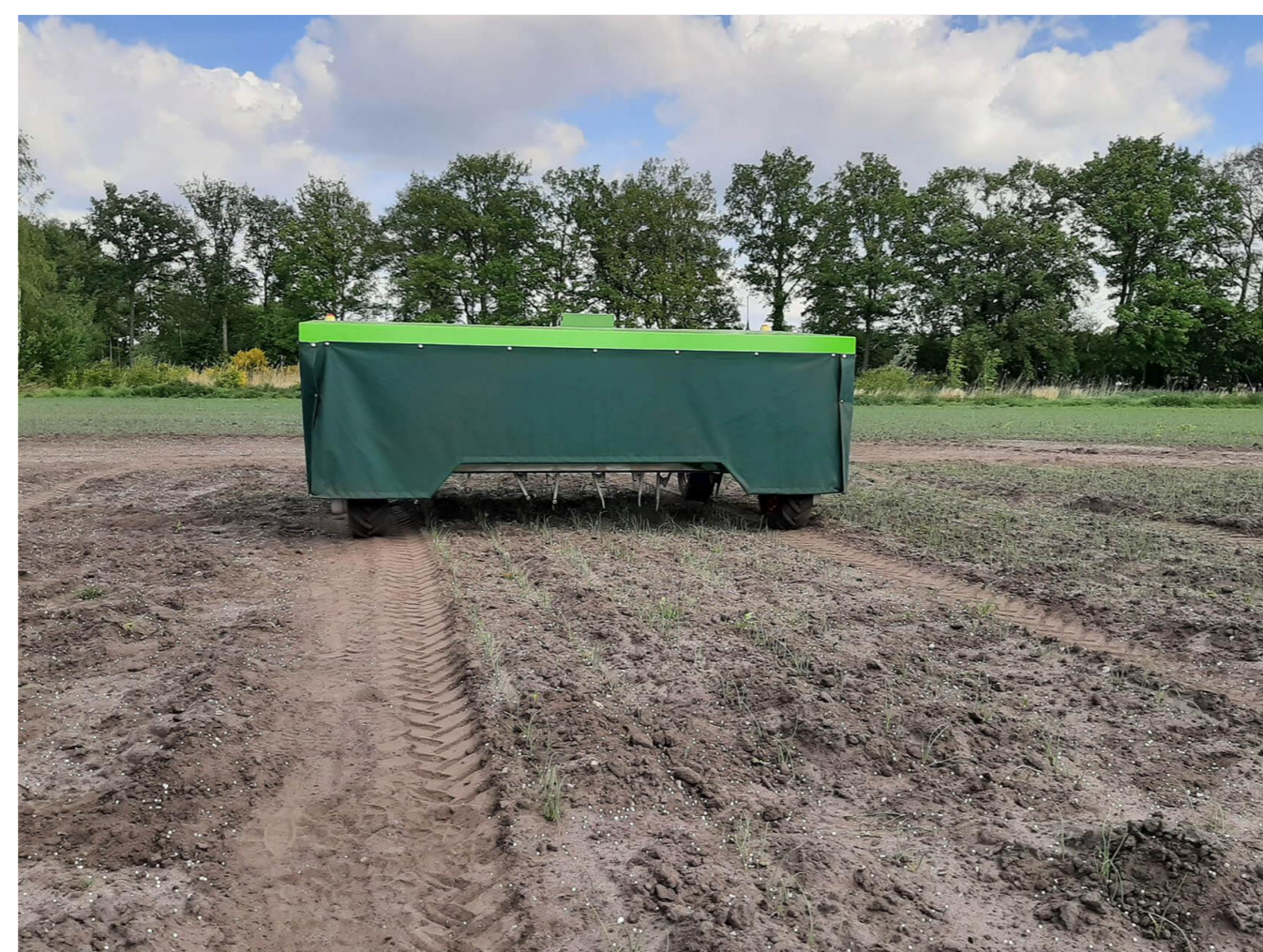
Figuur 1. de EKO BOT is een onkruidrobot die getest is voor onkruidbestrijding in uien bij Boerderij van de Toekomst via de voucherregeling.
