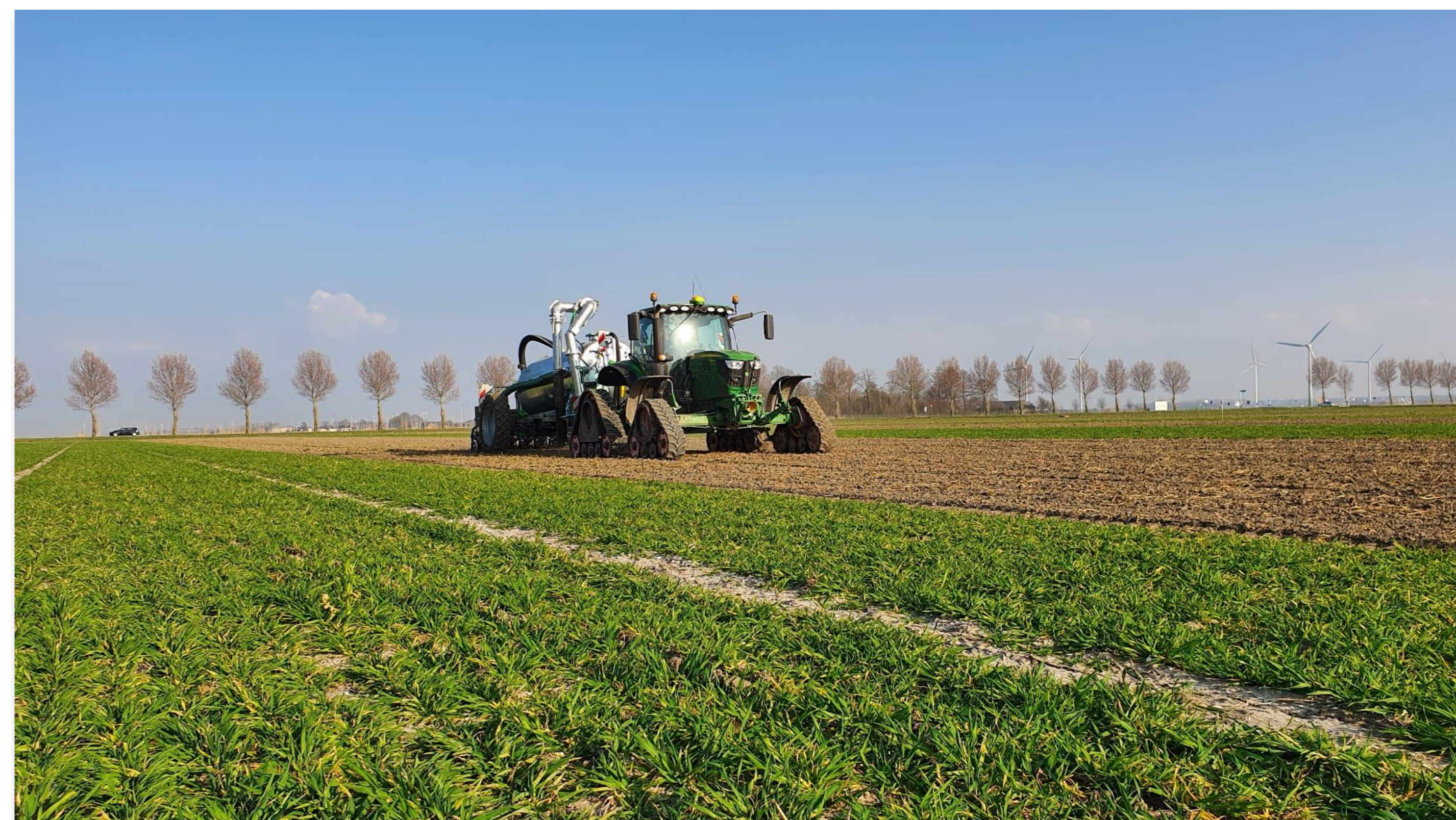
Figuur 4. Boerderij van de Toekomst ontwikkelt zelf ook nieuwe machines, zoals de mesttank op 3,15m rijpaden. Deze innovatieve technieken zijn gebouwd door partners in opdracht van Boerderij van de Toekomst.
