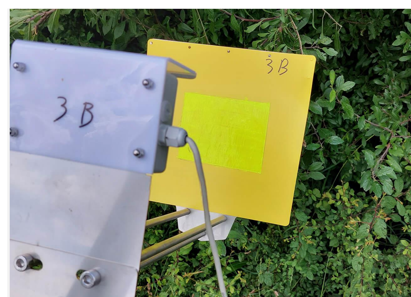
Figuur 2. Deze automatische insectenval van PESSL is getest om bladluizen te herkennen bij Boerderij van de Toekomst via de voucherregeling.
